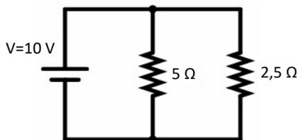
**53** – Assinale a alternativa que contém a potência total dissipada pelos resistores do circuito.
